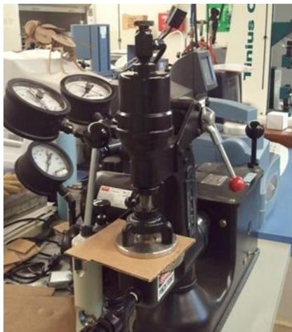
**Figure 3:** *Burst Tester*
